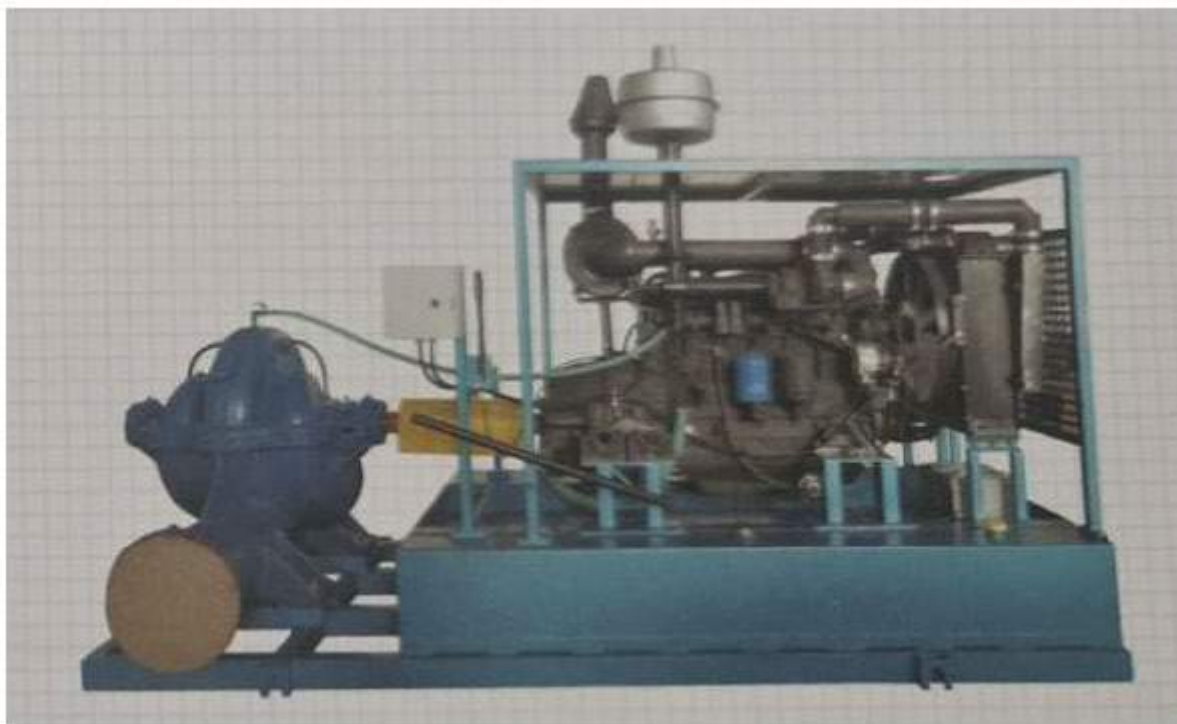
Рисунок 1-5 – Пересувна насосна станція СНВ(д) 200-60
