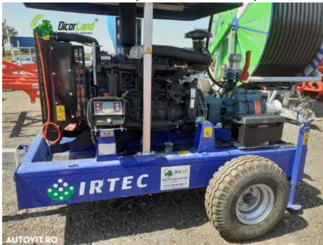
Рисунок 1-3 – Пересувна насосна станція І14С002
