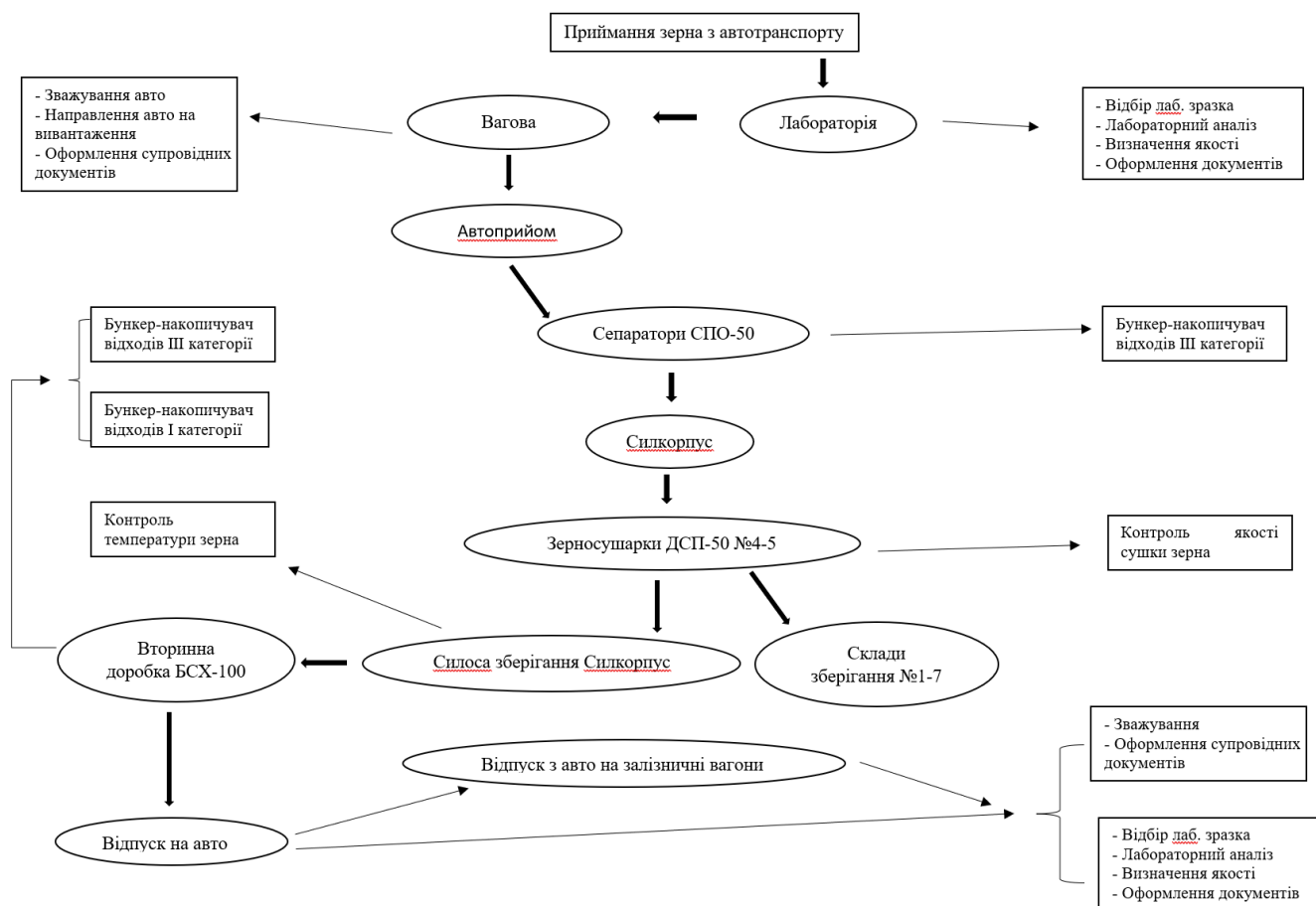
Рисунок 1.4 - Блок-схема виробничого процесу Елеватор №3
